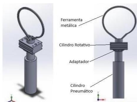
Figura 7 – Sistema para extração da castanha do coco.
